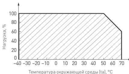
Рис. 2. Максимальная допустимая нагрузка, % от мощности источника
